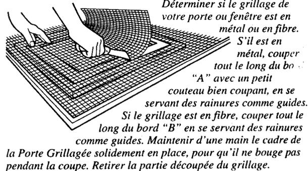
*Déterminer si le grillage de votre porte ou fenêtre est en métal ou en fibre. S'il est en métal, couper tout le long du bord "A" avec un petit couteau bien coupant, en se servant des rainures comme guides. Si le grillage est en fibre, couper tout le long du bord "B" en se servant des rainures comme guides. Maintenir d'une main le cadre de la Porte Grillagée solidement en place, pour qu'il ne bouge pas pendant la coupe. Retirer la partie découpée du grillage.*
